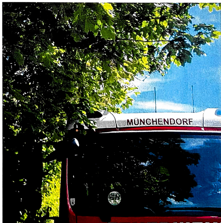
Tiefhängende Äste, die nicht rechtzeitig abgeschnitten wurden, können Schäden der Ausrüstung auf dem Dach oder an der Seite von Einsatzfahrzeugen verursachen
